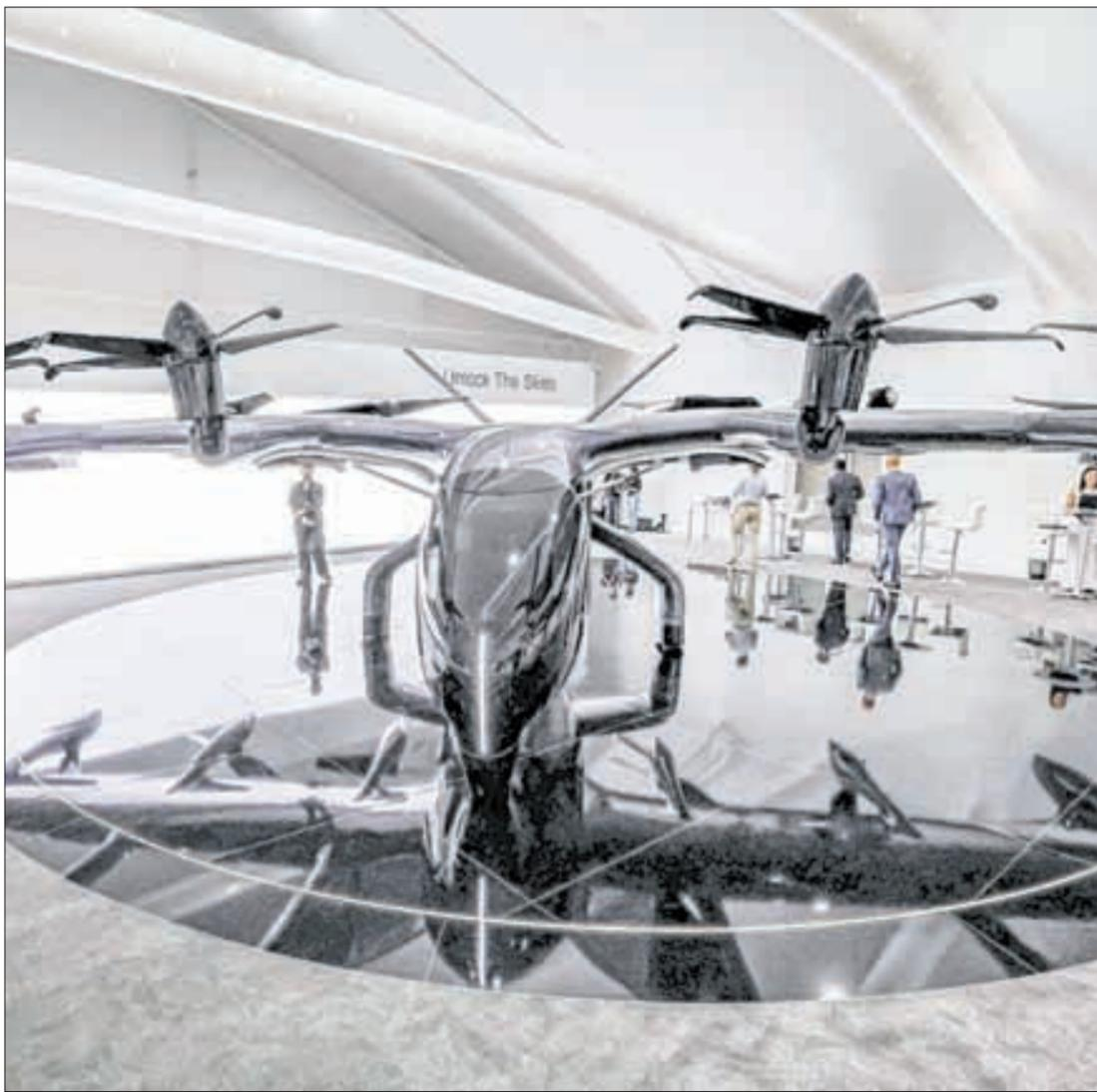
▲ *Midnight* despegue y aterriza de manera vertical. Posee una docena de hélices alimentadas de forma independiente para minimizar el riesgo de avería, y un ala que le permite planear si falla el motor. Se
